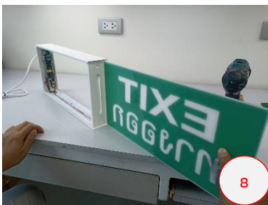
ประกอบแผ่นป้ายด้านที่ 1 เข้ากับ ตัวเครื่อง
