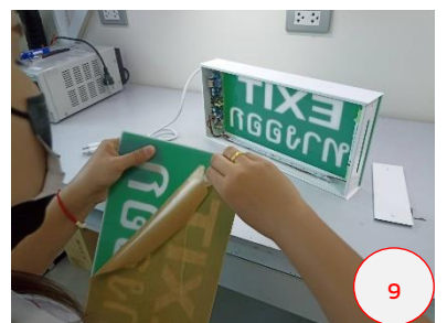
ลอกแผ่นกันรอยแผ่นป้ายทางออก แผ่นที่ 2 ออก
