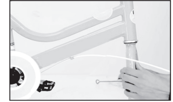
6. ประกอบตะแกรงซ้อนท้ายเข้ากับข้อต่อและชันน็อตให้แน่น 7. ประกอบอานและหลักอานให้เข้าที่ 8. จากนั้นประกอบให้เข้ากับโครงรถ พร้อมชันน็อตให้แน่น 9. ประกอบบันไดโดยดึงเคดเครื่องหมายที่ระบุข้างซ้าย/ขวาให้ถูกต้อง 10. หมุนตะเกียบล้อหน้าตั้งตรง และประกอบเบรกหน้า
