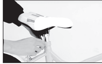
6. ประกอบตะแกรงซ้อนท้ายเข้ากับข้อต่อและชันน็อตให้แน่น 7. ประกอบอานและหลักอานให้เข้าที่ 8. จากนั้นประกอบให้เข้ากับโครงรถ พร้อมชันน็อตให้แน่น 9. ประกอบบันไดโดยดึงเคดเครื่องหมายที่ระบุข้างซ้าย/ขวาให้ถูกต้อง 10. หมุนตะเกียบล้อหน้าตั้งตรง และประกอบเบรกหน้า
