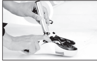
6. ประกอบตะแกรงซ้อนท้ายเข้ากับข้อต่อและชันน็อตให้แน่น 7. ประกอบอานและหลักอานให้เข้าที่ 8. จากนั้นประกอบให้เข้ากับโครงรถ พร้อมชันน็อตให้แน่น 9. ประกอบบันไดโดยดึงเคดเครื่องหมายที่ระบุข้างซ้าย/ขวาให้ถูกต้อง 10. หมุนตะเกียบล้อหน้าตั้งตรง และประกอบเบรกหน้า
