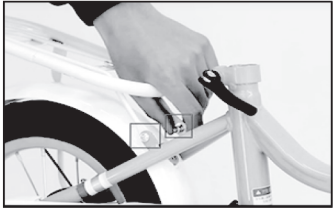
6. ประกอบตะแกรงซ้อนท้ายเข้ากับข้อต่อและชันน็อตให้แน่น 7. ประกอบอานและหลักอานให้เข้าที่ 8. จากนั้นประกอบให้เข้ากับโครงรถ พร้อมชันน็อตให้แน่น 9. ประกอบบันไดโดยดึงเคดเครื่องหมายที่ระบุข้างซ้าย/ขวาให้ถูกต้อง 10. หมุนตะเกียบล้อหน้าตั้งตรง และประกอบเบรกหน้า
