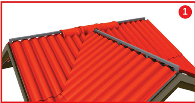
เริ่มจากการวางกรอบสันหลังคาตัวแรกให้ตรงตำแหน่งที่แนวสันหลังคา อีกด้านหนึ่งที่มาบรรจบ แล้วยึดด้วยคัลเลอร์สกรูไตรลอน/สกรูคลาส 3
