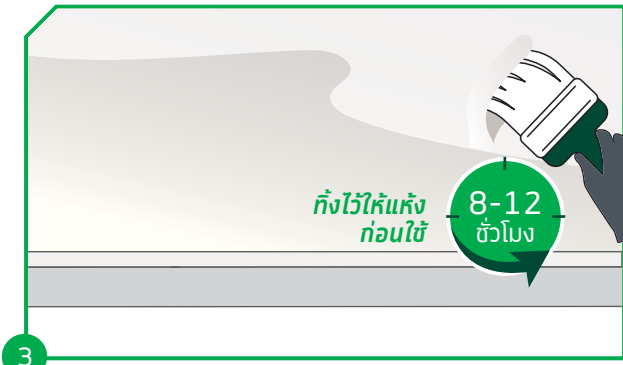
3 ทาฟิล์มกั้นที่ เฌอรา ท็อปการ์ดให้ทั่วแผ่นพื้น เฌอรา บอร์ด จำนวน 2 เที่ยว ทิ้งไว้ให้แห้งประมาณ 8-12 ชม. ก่อนใช้งานจริง
